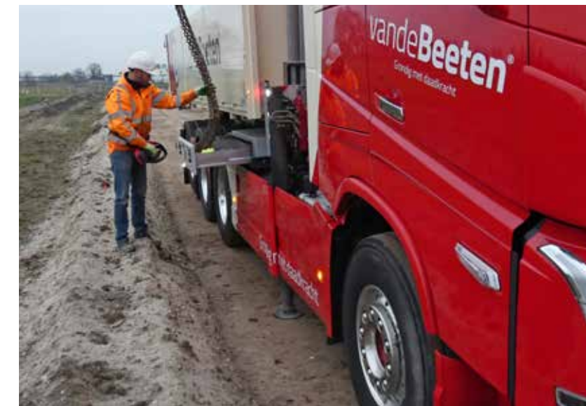
Sander kan de kettingen zo in de lade laten zakken. Dat scheelt veel zwaar handwerk.
